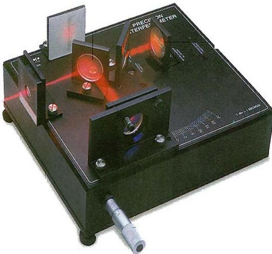
L'esperimento mostra che la velocità della luce non dipende dal moto relativo della Terra rispetto al sole ed esclude l'esistenza dell'etere. La luce si propaga alla velocità  $c=3 \cdot 10^8$  m/s in tutti i sistemi di riferimento.
